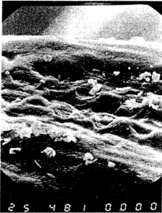
Abb. 3. Gipskristalle auf der Oberfläche einer Fichtennadel; REM - Aufnahme
