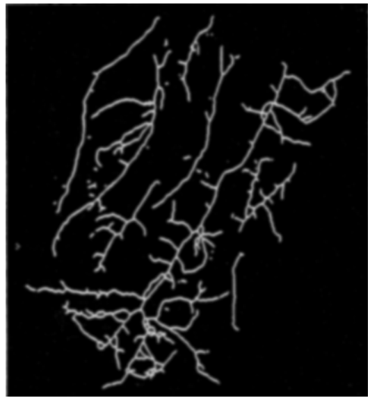
Abb. 4. Skeleton des Binärbildes; Voraussetzung für eine exakte Längenmessung Fig. 4. Skeleton of the binary image; necessary for correct length measurement
