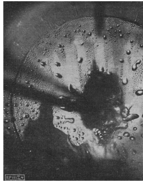
Abb. 4. Kondensation an einer nicht mehr ganz sauberen Kupferplatte (oben Tropfen-, unten Filmkondensation)
