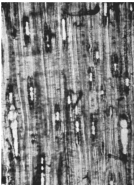
Bild 2. Tangentialschnitt von wassergelagertem Kiefernholz mit bakteriell abgebauten Markstrahlen.
