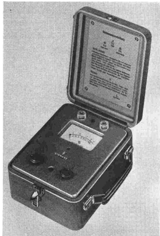
Bild 6. Das Siemens & Halske - Holzfeuchtigkeitsmeßgerät.
