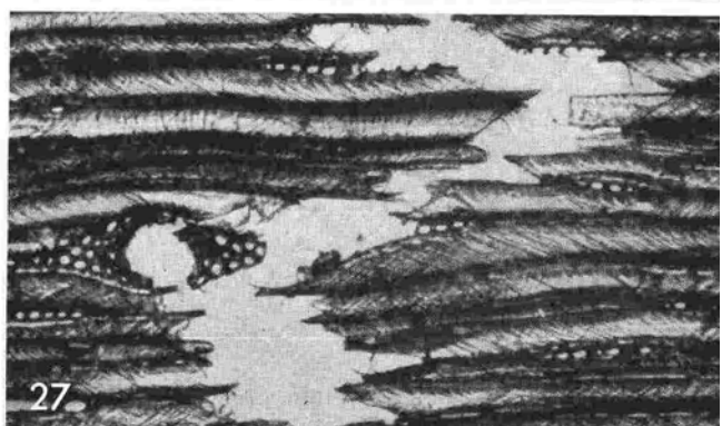
Bild 25. T_L - SH_S : Probendicke 20\ \mu\text{m} ; breite Markstrahlen mit Harzkanal in unbelastetem Zustand. Vergr. 140 : 1.
