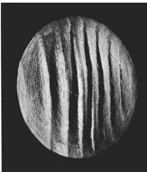
Bild 20. Kugel aus Buchenholz nach Verformung unter allseitigem Druck von 600 kp/cm 2 und 170° C Temperatur.
