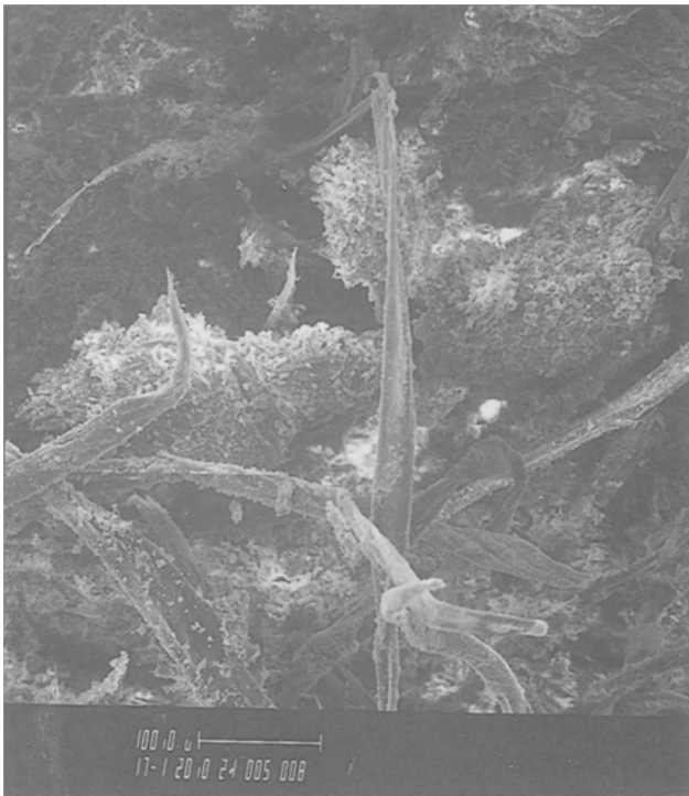
Photo 1 – Surface de rupture des plâtres renforcés de fibres de cellulose.
