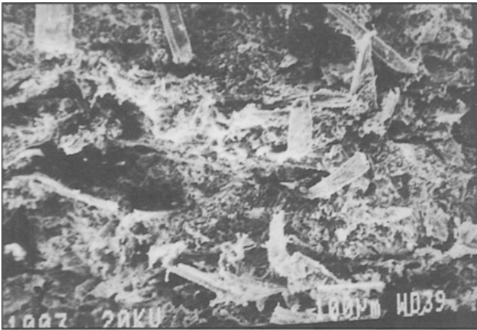
Photo 5 – Surface de rupture du composite à l'état sec.
