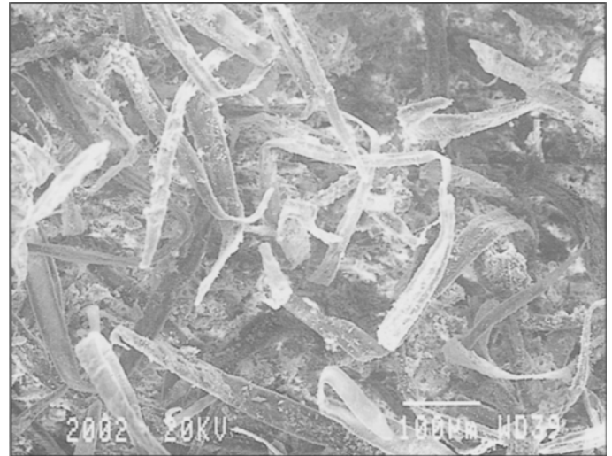
Photo 6 – Surface de rupture du composite à l'état ambiant.
