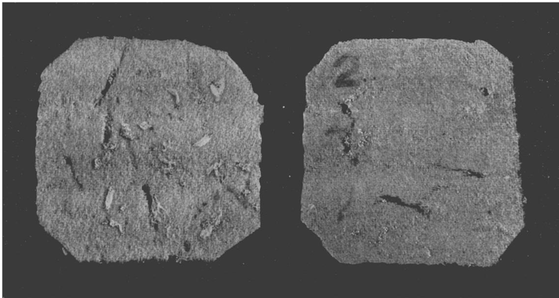
Abb. 2. Die durch Mottenfraß zerstörten unbehandelten Stoffproben „U“ und 2 (Originalgröße).
