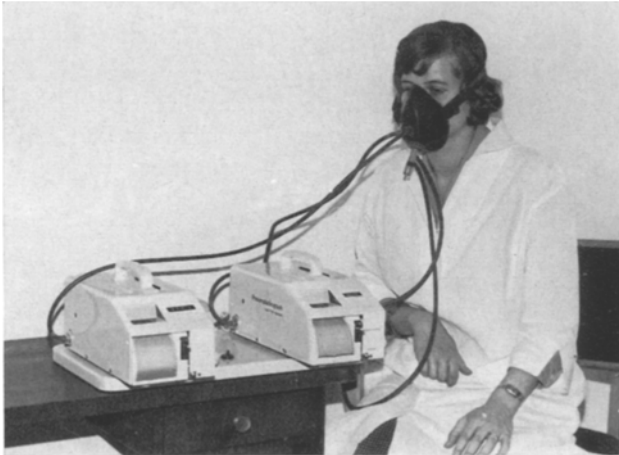
Abb. 1. Nasenwiderstandsmeßapparatur. Rechts Pneumotachograph, links Rhinomanograph. Die Kurven werden synchron geschrieben und mit Hilfe eines Meßrasters ausgewertet
