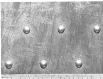
Abb. 6h. Kalotten, Platte XIII. k = 0,8 cm; k = 0,26 cm; D = 4,0 cm; k_s = 0,031 cm.
