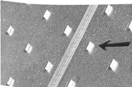
Abb. 6p. „Kurzze“ Winkel, Platte XVI. c = 0,8 \text{ cm} ; k = 0,30 \text{ cm} ; D = 4,0 \text{ cm} ; k_s = 0,291 \text{ cm} .
