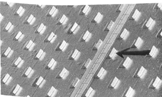
Abb. 6p. „Kurzze“ Winkel, Platte XVI. c = 0,8 \text{ cm} ; k = 0,30 \text{ cm} ; D = 4,0 \text{ cm} ; k_s = 0,291 \text{ cm} .
