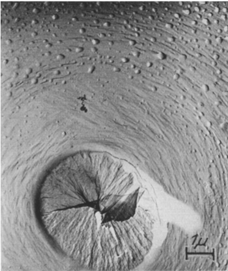
Abb. 3. Innere Hoftüpfelwandung von Pinus silvestris mit größeren und kleineren Warzen; el. opt. 7600:1.
