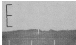
Abb. 18. 22. Juni 28. 31 o C. Lathyrus latifolius . Ableitung von einer Ranke. Reiz: Durchschneiden der Nachbarranke, 3,2 cm von der Ableitungsstelle. Zeitmarken 10 Sekunden, Spannungseinheit 0,02 Volt.
