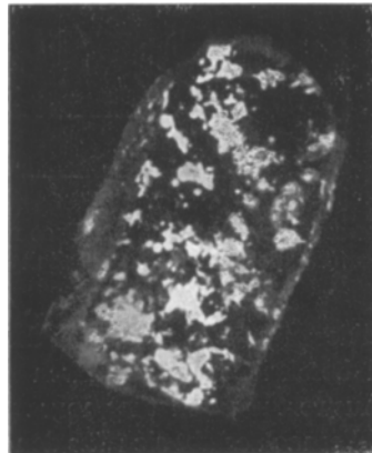
Abb. 5. Thermische Zersetzung des Epsomits unter dem Heitzischmikroskop bei ca. 50^{\circ} . Vergrößerung 24\times , gekreuzte Polarisatoren
