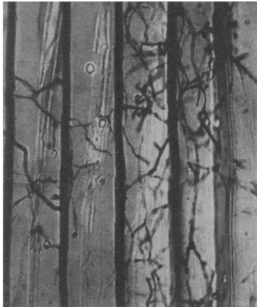
Abb. 11. Spiegelschnitt durch Fichtenholz mit Myzel von Polyporus vaporarius und Bohrlöchern. Versuchsdauer 40 Tage
