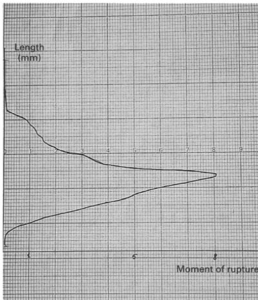
Fig. 4 Dynamometer test. X-axis: linear traction, in kgf/mm 2 or in MPa, y-axis: length of the studied strip Test au dynamomètre. En abscisse : force de traction en kgf/mm 2 ou MPa, en ordonnée : longueur du segment étudié
