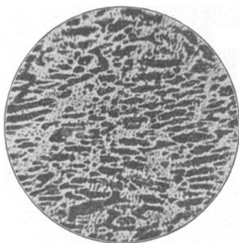
Fig. 4. Aktives Adsorbens (280mal). Die groben Diffusionshöhlräume sind schwarz; weiß ist die feste Substanz mit den aktiven Kapillaren, welche außerhalb des mikroskopisch Sichtbaren liegen (Aus: A. Engelhardt, Kolloid-Z. 71, 238 [1935]).
