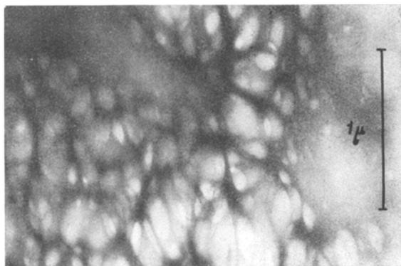
Fig. 1 (2921/40). Auftrocknung aus einer Suspension von Baumwolle, die mehrere Tage mit HCl abgebaut, neutralisiert und dialysiert wurde. Elektronenoptisch: 30000:1.
