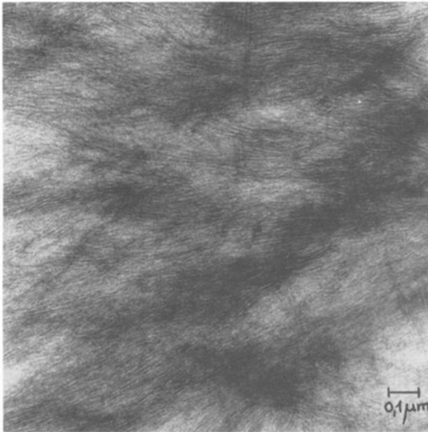
Abb. 1. Lamellare Feinstruktur einer aus der Schmelze langsam abgekühlten Polyamid-6-Probe, kontrastierter Ultra-Dünnschnitt
