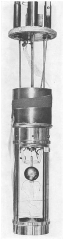
Fig. 2. Innerer Teil der Apparatur mit montierter Probe. Die Zange, die die Probe mit dem hier gezeigten inneren He-Gefäß thermisch verbinden kann, ist geöffnet
