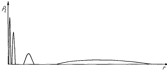
Fig. 2. P_l als Funktion von r für das Valenzelektron im 4s-Zustand des K-Atoms
