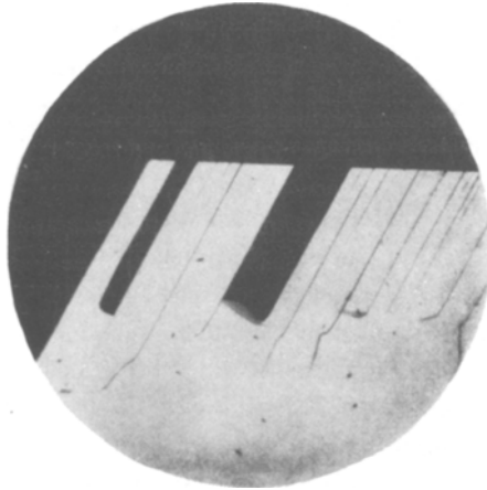
Fig. 3. Kristallographisch begrenzter Bruchrand eines Glimmerblättchens. (50mal, gekrenzte Nicols).
