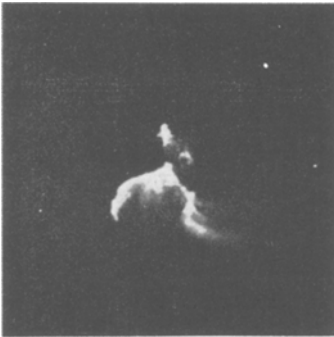
Fig. 9. Reißstelle eines Cd-Kristalls mit annähernder Querlage der Basis. \varphi = 40 .
