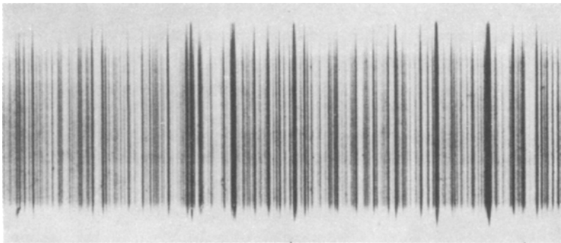
Fig. 5. Vergrößerter Ausschnitt aus dem mit einem 3 m-Konkavgitter aufgenommenen Beck-Bogen-Spektrum. Dispersion 1,4 Å/mm. Der nur 150 Å umfassende Ausschnitt zeigt die Liniendichte des Spektrums.
