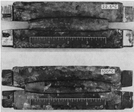
Fig. 14. Photograph of pillar models showing vertical deformation at 22.5° C and 100° C Pfeilermodelle mit den vertikalen Deformationen bei 22,5° C und 100° C
