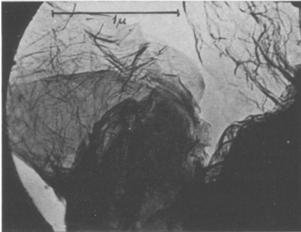
Abb. 1. Elektronenmikrobild von Graphitoxhydroxydruß 4, elektronenmikroskopische Vergrößerung 34,500 fach.
