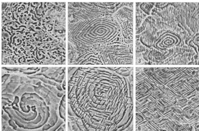
Fig. 1—6. 1 Phenanthren auf Fluoren. 2 Chloranil auf 2,3-Benzofluoren. 3 Bromural auf Phenanthren. 4 Pikrinsäure auf 2,3-Benzofluoren. 5 Hexachlorbenzol auf 2,3-Benzofluoren. 6 Phthalanil auf 2,3-Benzofluoren.
