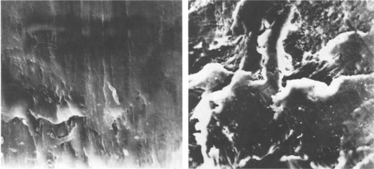
Abb. 3. Veränderung der effektiven Oberfläche von PTFE bei Behandlung mit konz.  $\text{HNO}_3$  bei ca.  $170^\circ\text{C}$  in einem Druckgefäß. Links: unbehandelt (ERM: 3000fach vergrößert). Rechts: nach  $\text{HNO}_3$ -Behandlung (ERM: 1000fach vergrößert)
