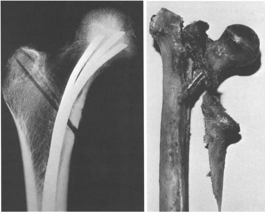
Abb. 1. Modell stabiler petrochanterer Fraktur vor und nach Belastung
