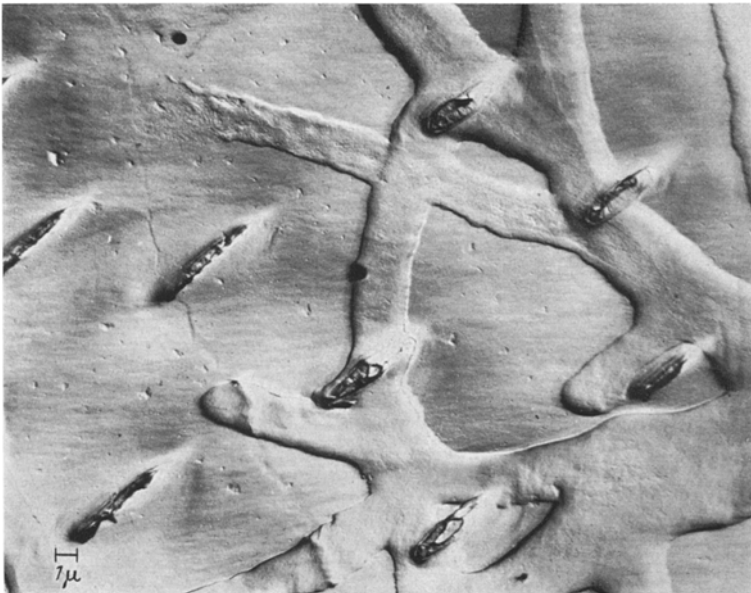
Abb. 4. Enzymatische Auflösung einer Gefäßwand durch Hyphen von Polyporus versicolor ; die Lysiszonen sind kanalförmig eingesenkt; 2900fach
