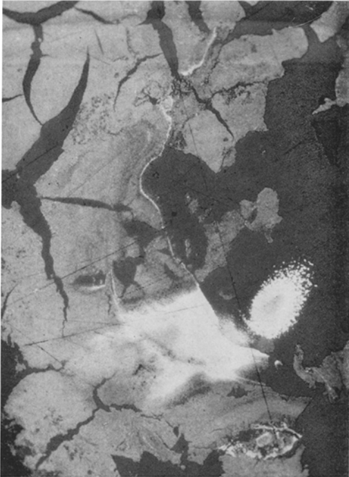
Fig. 4. Croute de galène sur le batonnet de circulation des gouttes. Examen en lumière réfléchie. G = 162
