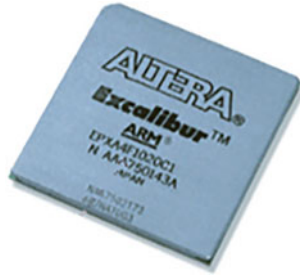
Fig. 1.6 World’s first SoC FPGA—Altera excalibur
