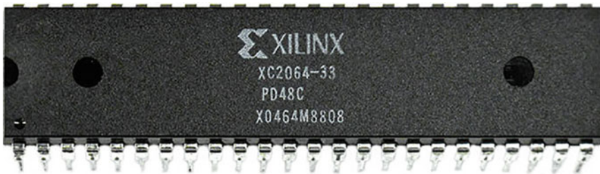
Fig. 1.2 World’s first FPGA—Xilinx XC2064
