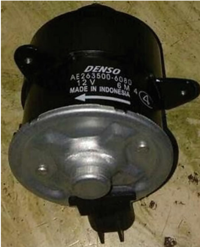
Fig. 3 Radiator fan motor
