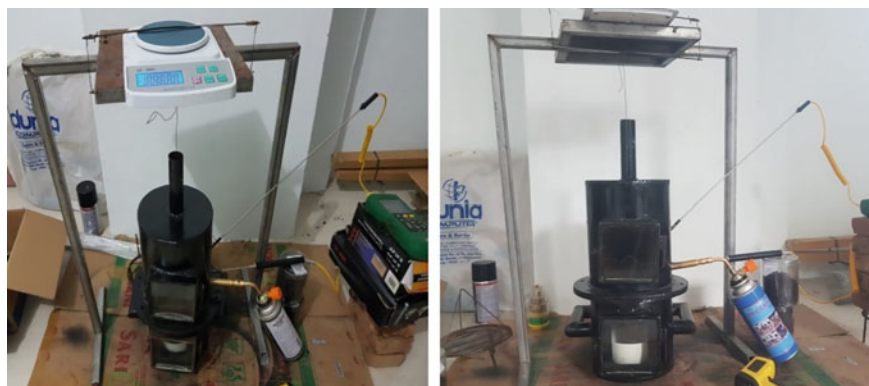
Fig. 2 Combustion test apparatus
