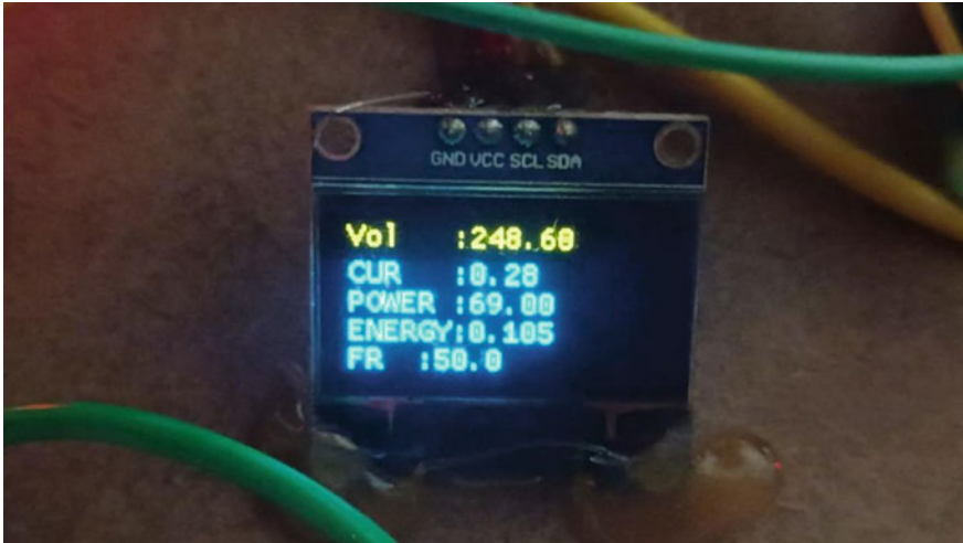
Fig. 3 Parameters monitoring on display
