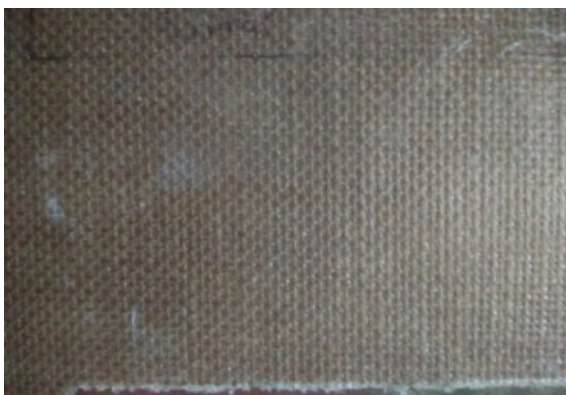
Fig. 2 Fabricated composite plate-Plate 2 (Jute-Sisal-Jute)
