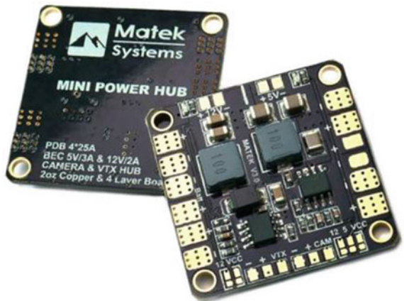
Fig. 10 Matek mini power hub PDB (BEC 5 and 12 V)
