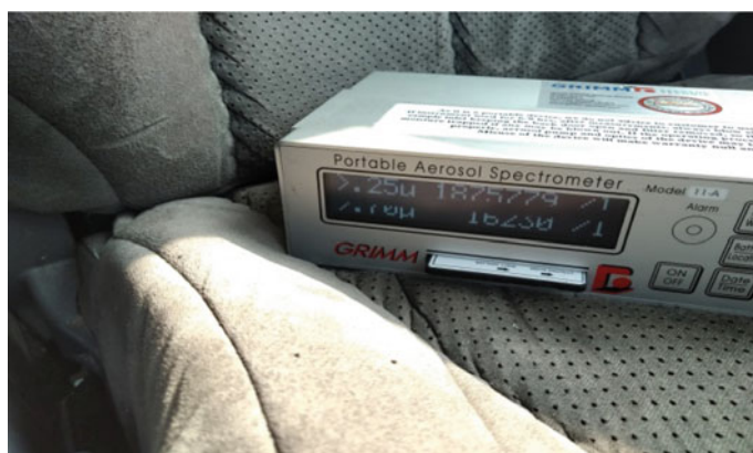
Fig. 2 GRIMM Technik, model 11-A portable aerosol spectrometer
