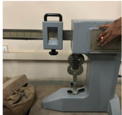
(d) Tensile strength testing of mortar briquet samples
