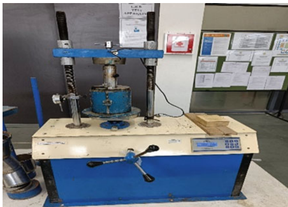
Fig. 6 CBR test apparatus
