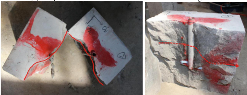
(d) Sample D4: Hydraulic fracture turn when encountering the hole
