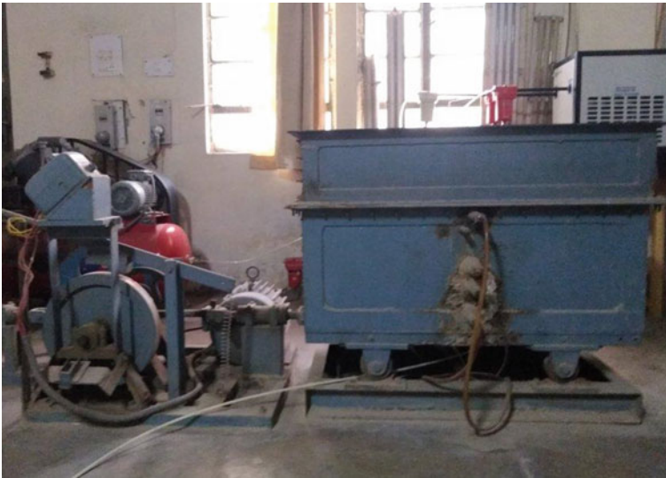
Fig. 45.1 Shaking table apparatus
