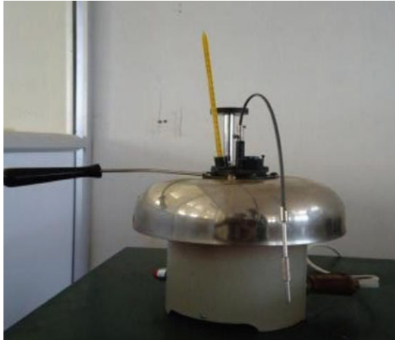
Fig. 3 Pensky Martin flash apparatus
