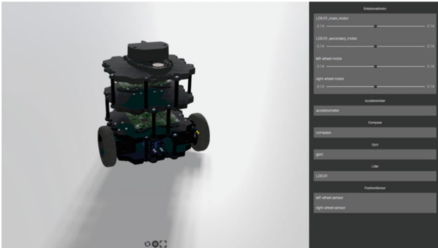
Fig. 6 Turtlebot3 mobile robot Webots
