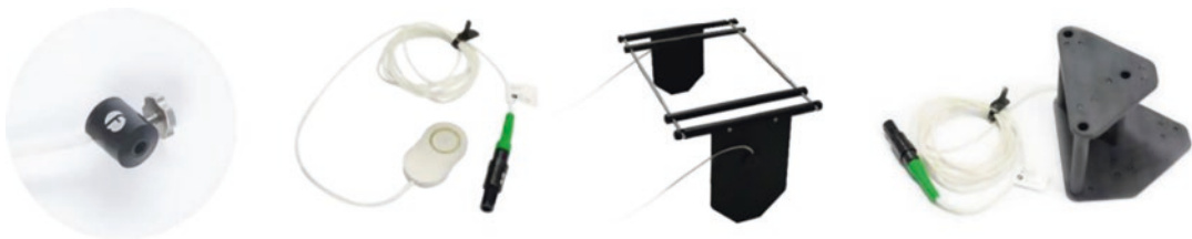
Fig. 12.2 The EM navigation module and tracking pointer
