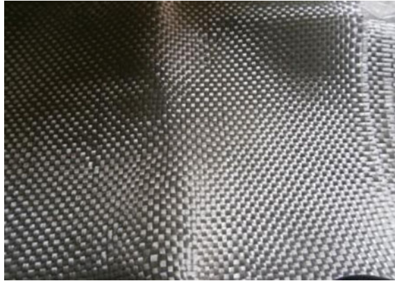
Fig. 1 Woven fiber 600 gsm
