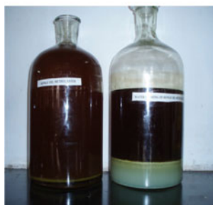
(d) DSOME washing and moisture removal
