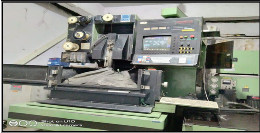
Fig. 2 Sodick wire EDM set-up
