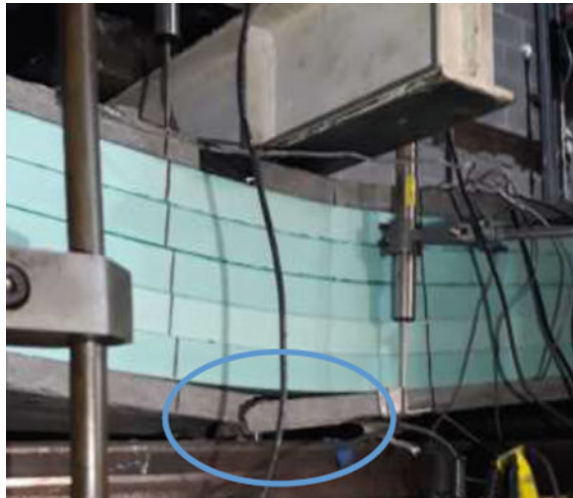
Fig. 28 Unconnected thin UHPFRC wythe PCSP close to failure (Lipszyska et al. 2020)
