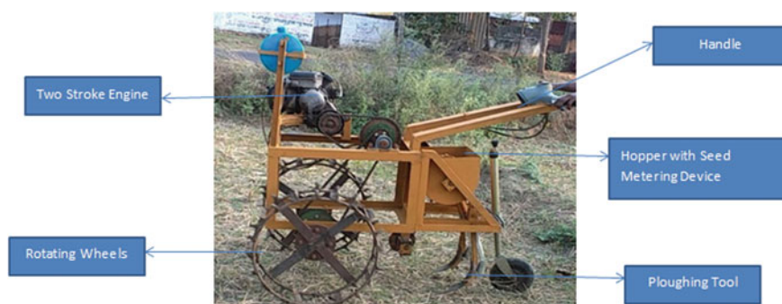
Fig. 5 Seed sowing machine
