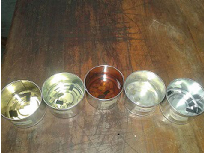
Fig. 18.6 Moisture test specimens
